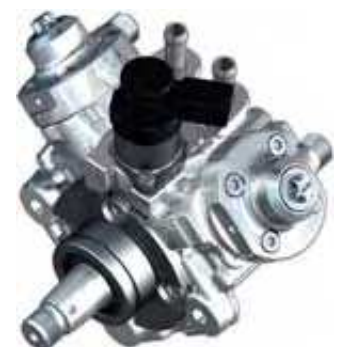
Dieselové čerpadlo CP4 pracuje s tlakem až 2000 barů
