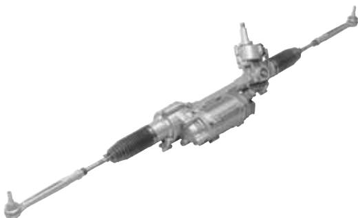
Servolectric® EPSsapa – Převodka řízení s paralelními osami
