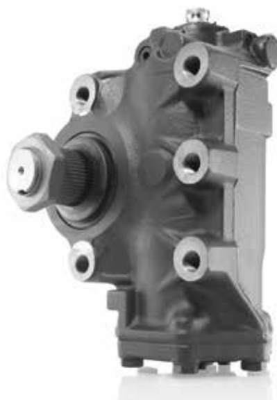
RB Servocom® – nejčastěji používaný systém řízení užitkových vozidel
