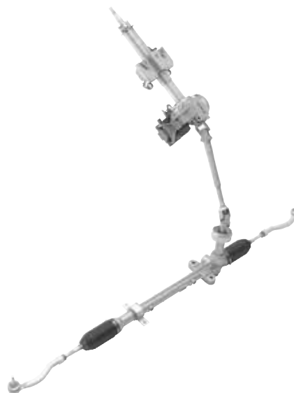
Servoelectric® EPSc – Elektromotor na sloupku řízení
